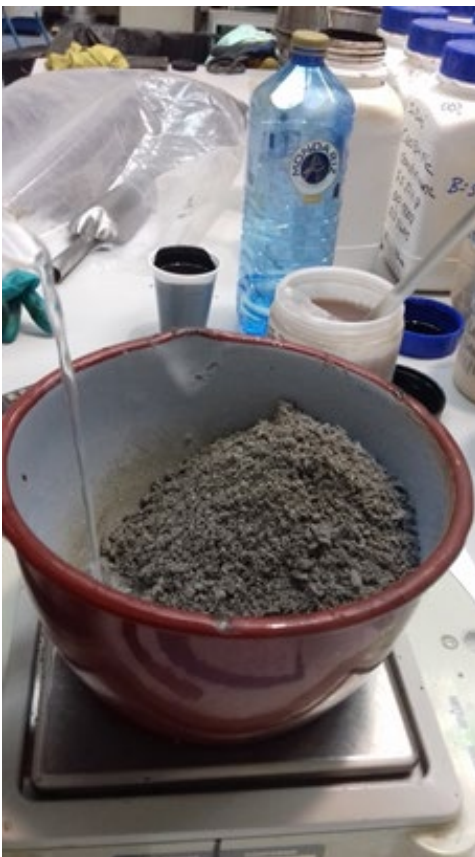
Fotografía 24: Dosificación del agua de preenvuelta en laboratorio.
