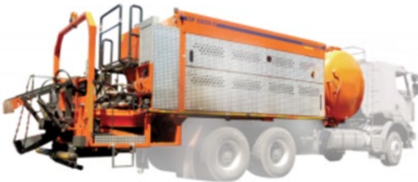
Fotografía 37.- Equipo para la fabricación y extensión de Microaglomerados en frío.
