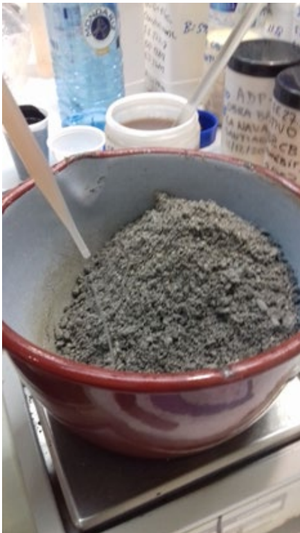
Fotografía 23: Dosificación de aditivo en laboratorio.
