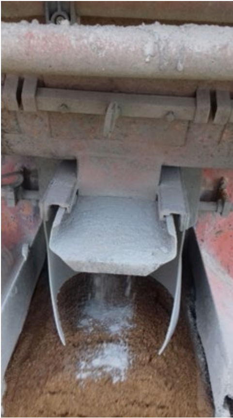
Fotografía 25: Dosificación del filler de aportación en el equipo de fabricación y extendido.
