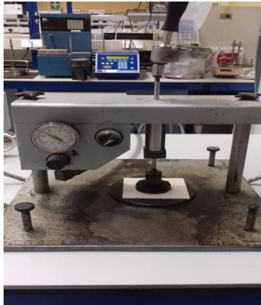
Fotografía 31.- Determinación de la cohesión de una lechada mediante el cohesiómetro.
